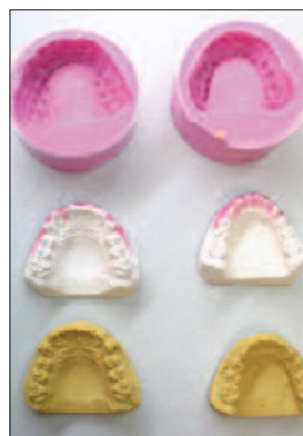
Abb. 1: Anzeichnen des prothetischen Äquators (Modellgussverfahren). – Abb. 2: Herstellung der Dublierform aus Silikon. – Abb. 3: Silikonform, Anfangsmodelle, Einbettmassemmodelle (gelb).
